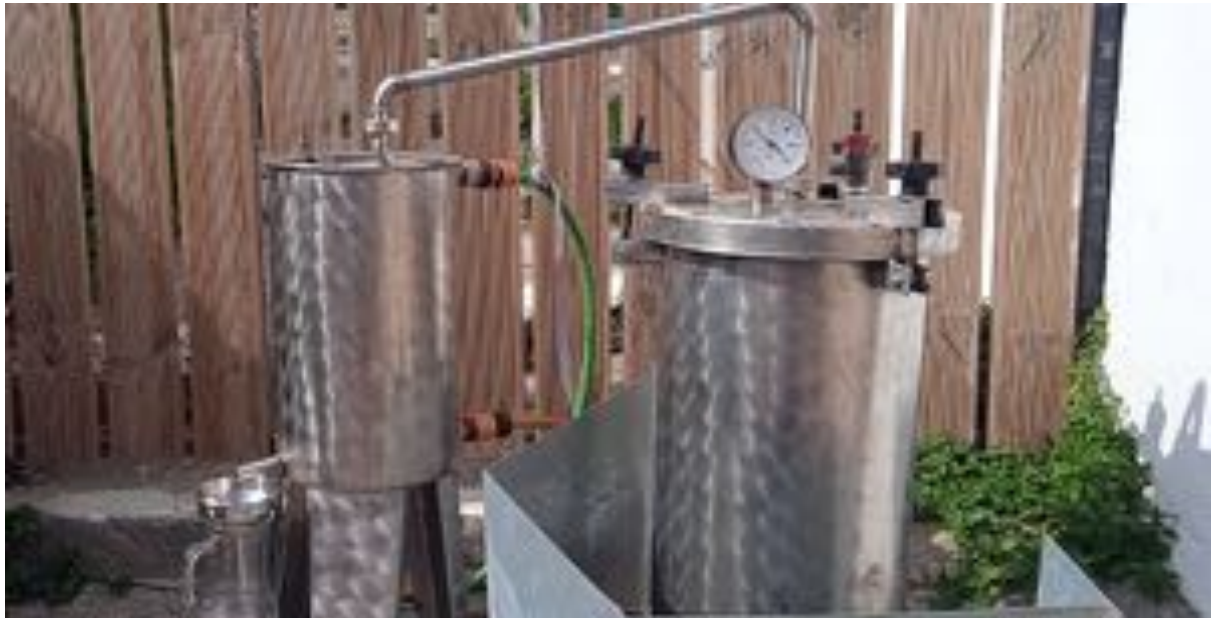
De destilleerketel (rechts) en de koeler (links), met onder het pijpje de glazen karaf waarin we de hydrosol opvangen
