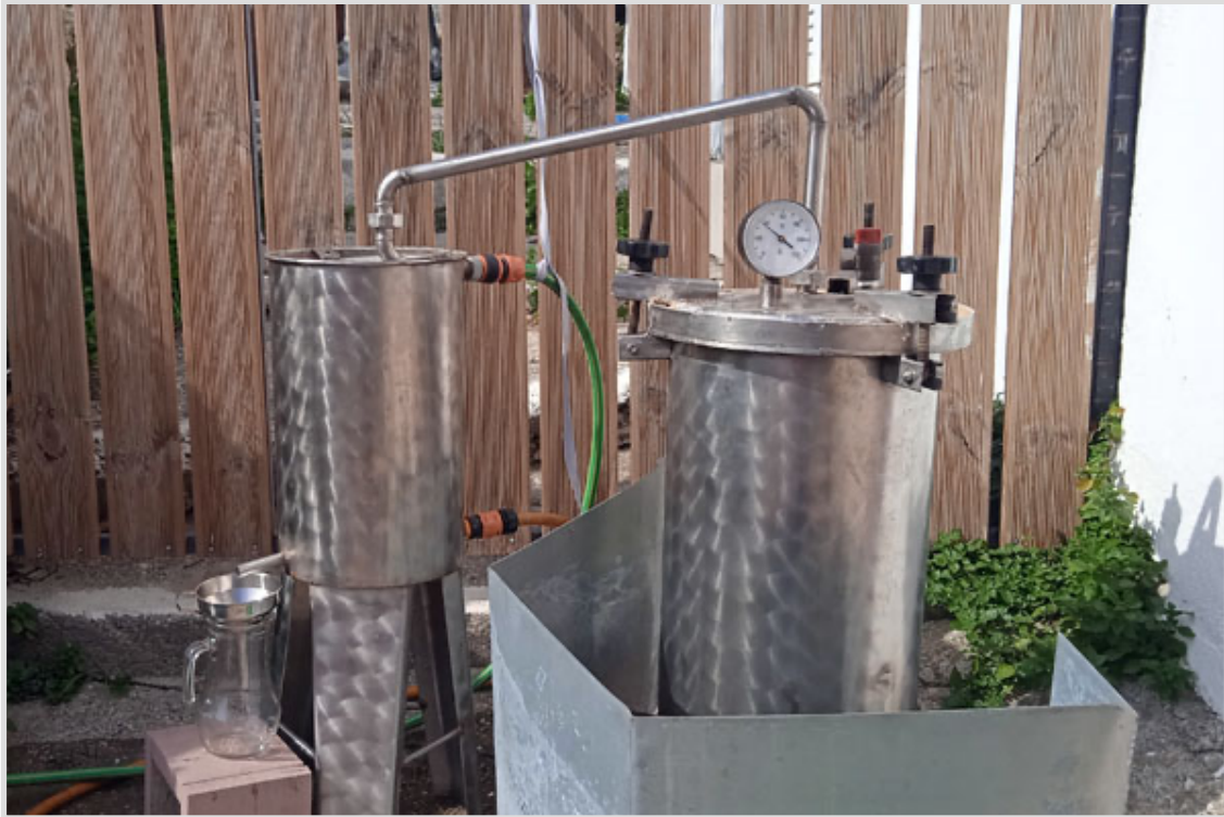
De destilleerketel (rechts) en de koeler (links), met onder het pijpje de glazen karaf waarin we de hydrosol opvangen
